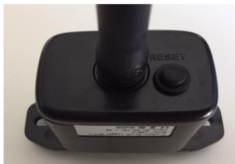
Figura 63 – Tasto di reset sulla scheda wifi
