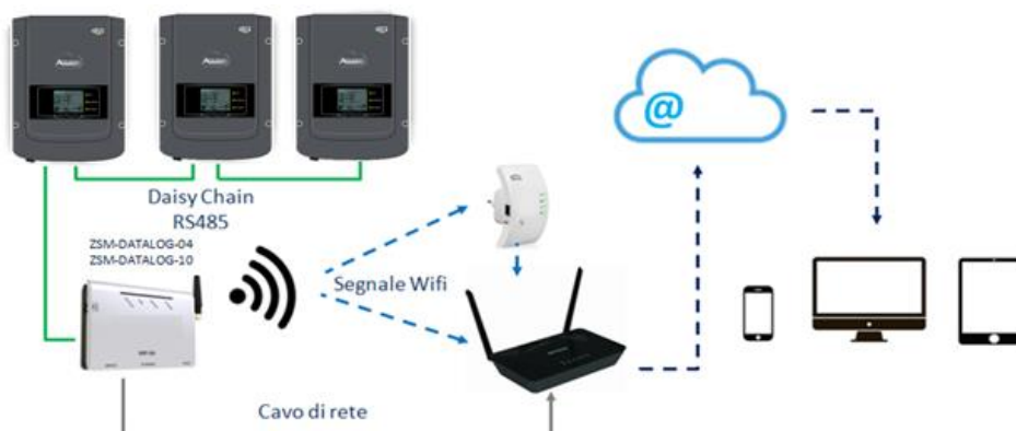
Figura 83 – Schema di connessione del datalogger ZSM-DATALOG-04 / ZSM-DATALOG-10
