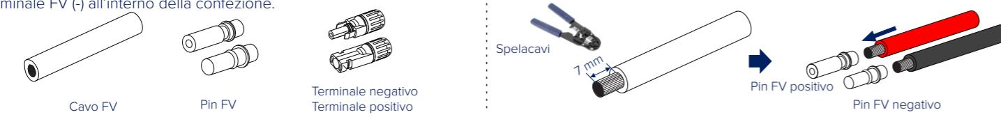
Passaggio 3. Il connettore FV è suddiviso in 2 parti: il connettore e la testa di fissaggio. Far passare il cavo attraverso la testa di fissaggio e il connettore di allineamento. Si noti che le linee rosse e nere corrispondono a diverse coppie di connettori. Infine, forzare il cavo nel connettore fino a sentire un "clic"; ciò indica che il collegamento è stata completato.
