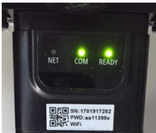
Figura 53 – Stato di comunicazione irregolare tra scheda e server remoto
