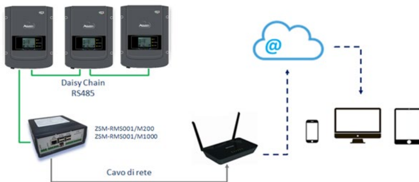
Figura 53 – Schema che mostra il funzionamento del datalogger ZSM-RMS001/M200 / ZSM-RMS001/M1000
