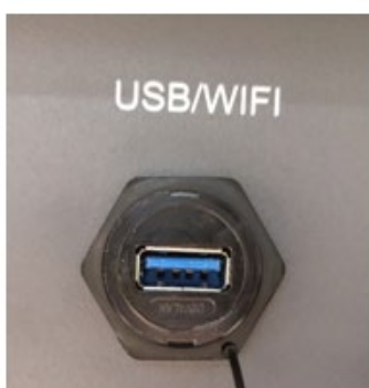
Figura 14 – Porta per adattatore WiFi esterno
